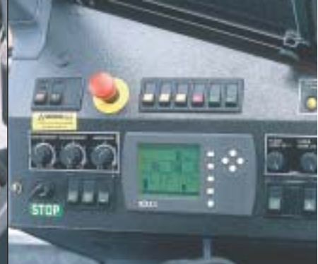
Styrsystemet IOAN ger dig den information du behöver. IOAN styr såväl arbetshydraulik som transmission.
