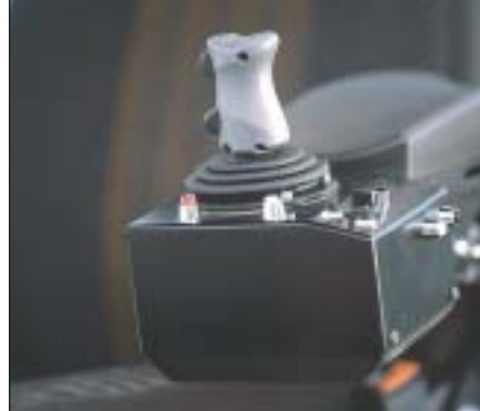
Digital överföring från ergonomiskt utformade Parker Can-spakar.
